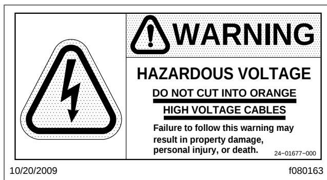
Fig. 16.2, Étiquette d'avertissement des câbles à haute tension
