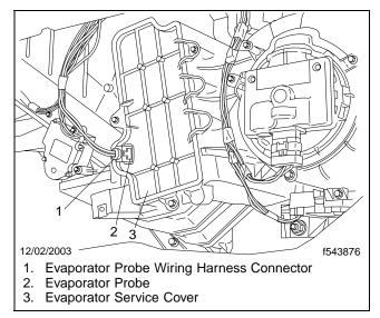
Fig. 1, Evaporator Probe
