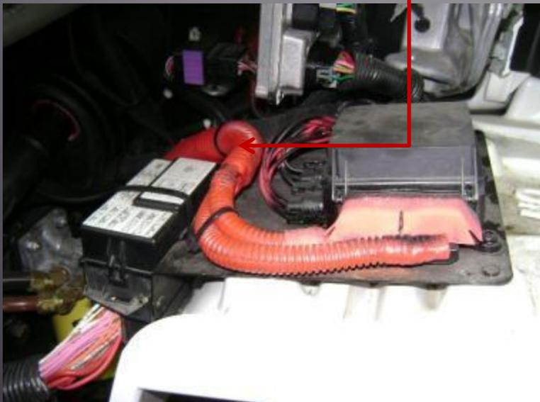
**NOTE: LES 2 FILS ROUGES POSITIFS PEUVENT TOUCHER SOUS LE "HOOD" ET S'USER PRÉMATURÉMENT (CORROSION)**
