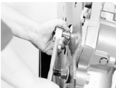
Loosen jam nut
