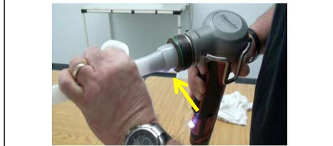
Figure 11 - Dilatation du montage
