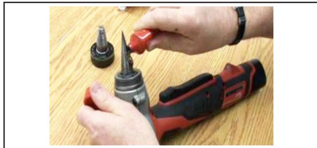
Figure 10 - Graissage du cône d'élargissement
