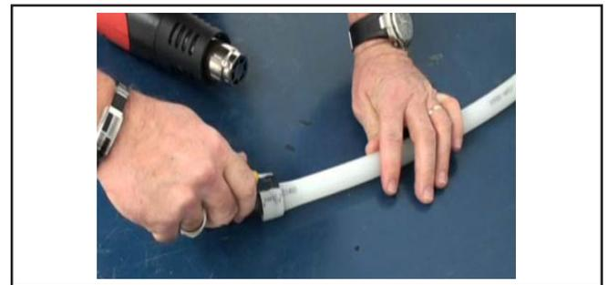
Figure 14 - Vérification de la solidité du tuyau
