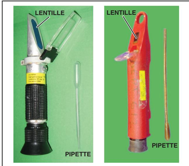
Figure 4 - Réfractomètres typiques
