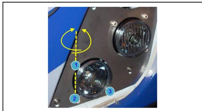
Figure B11 - Ajustement horizontal du phare côté rue
