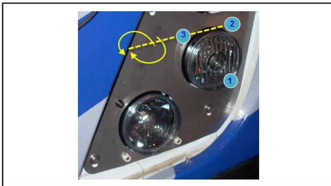
Figure B19 - Ajustement vertical du phare côté rue
