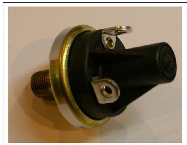
Figure 26 - Manocontact des feux d'arrêt (typique)
