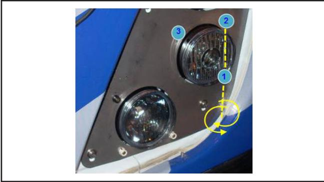
Figure B18 - Ajustement horizontal du phare côté rue
