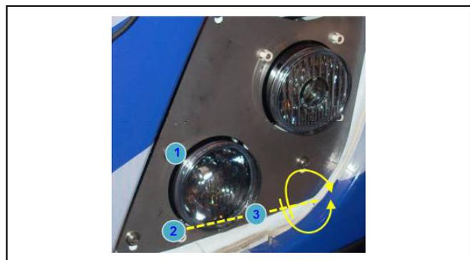
Figure B12 - Ajustement vertical du phare côté rue
