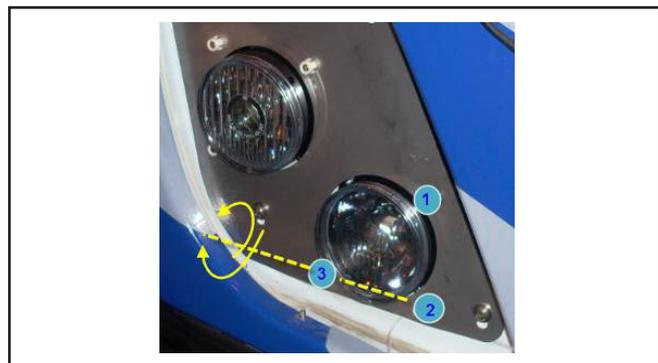
Figure B10 - Ajustement vertical du phare côté trottoir
