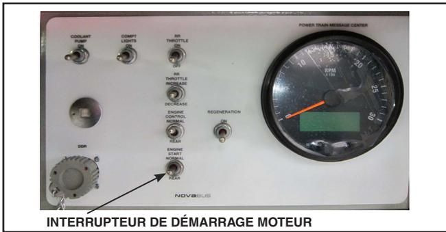
Figure 12 - Interrupteur de démarrage moteur dans le compartiment moteur (typique)
