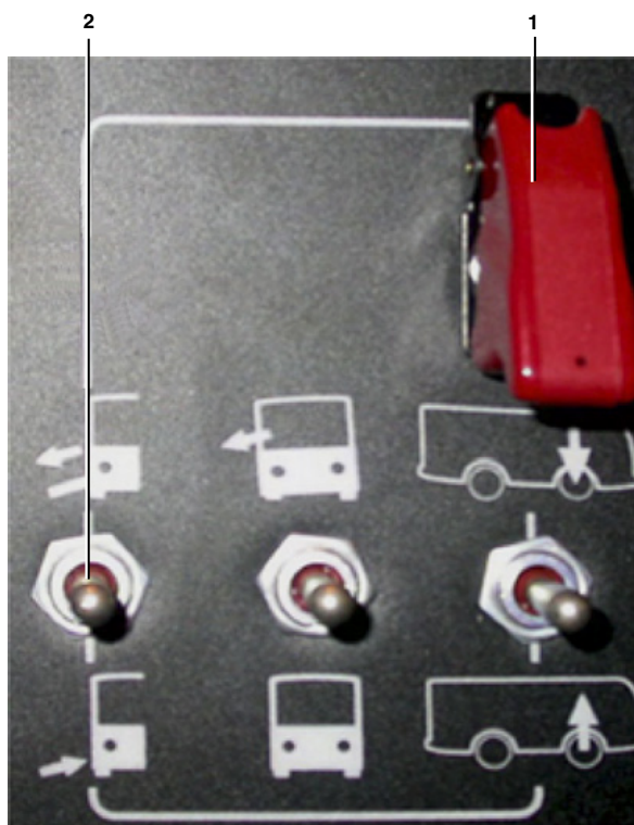
Figure 3 - Interrupteurs de la rampe
