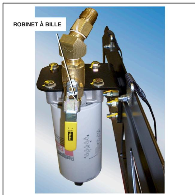
Figure 3 - Le robinet à bille sur le filtre primaire de 10 microns
