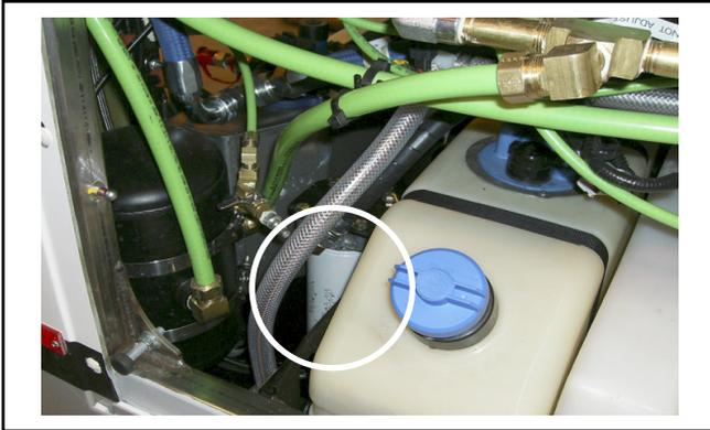
Figure 4 - Filtre de 10 microns
