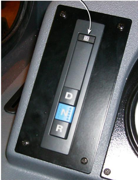
Figure 3 - Sélecteur de rapports et connecteur de diagnostic
