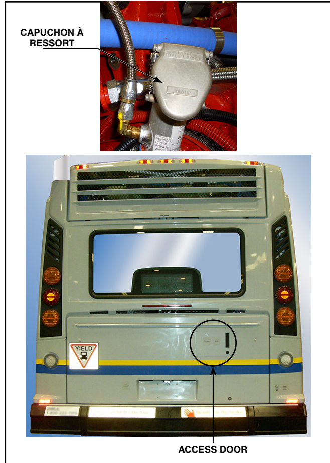
Figure 3 - Capuchon à ressort et petite porte d'accès
