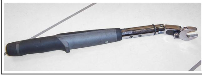
Figure 9 - Clé dynamométrique avec clé pied-de-biche
