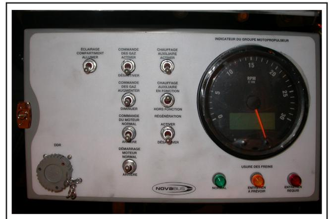
Figure 2- Boîtier de commande du moteur arrière (typique)
