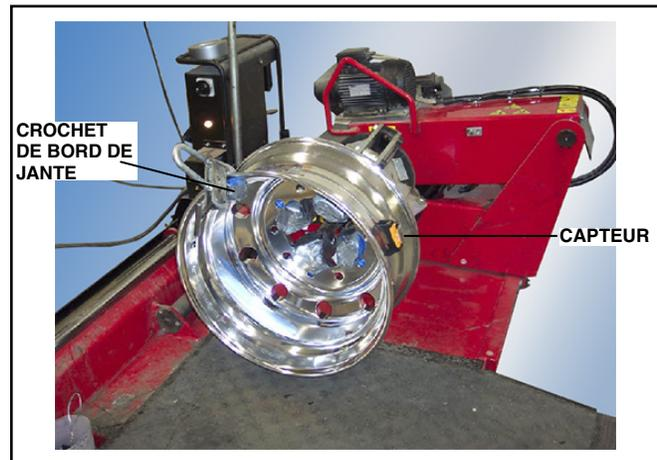
Figure C3 - Placer la jante sur la machine
