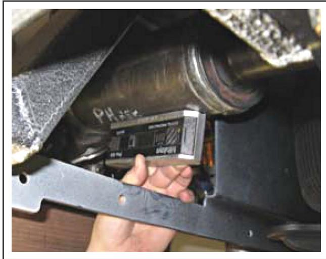
Figure 6 - Mesure de l'angle d'inclinaison de l'arbre de transmission
