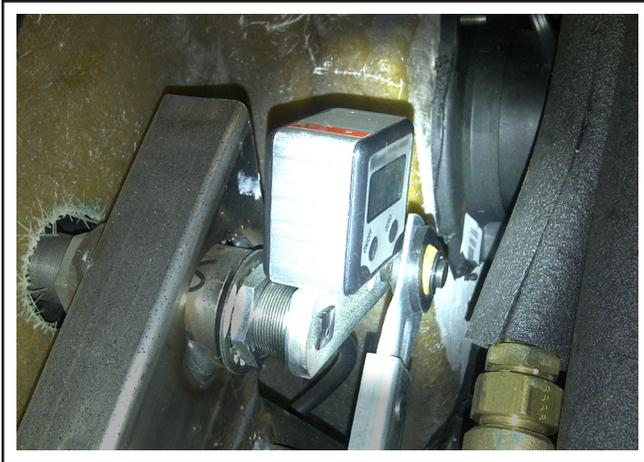
Figure 12 - Rapporteur d'angle numérique sur manivelle
