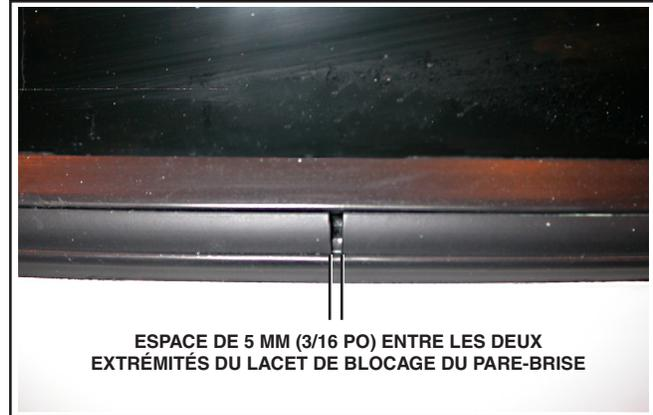
*Figure 4 - Installation de la vitre du pare-brise*
