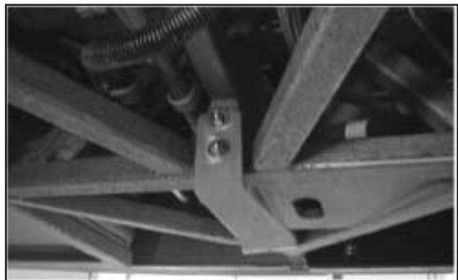
Figure A2 - Support installé sur les goujons au point arrière « A »
