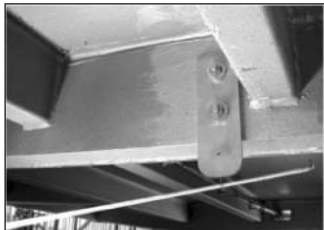
Figure B2 - Support central installé sur les goujons et ruban à mesurer fixé par la vis
