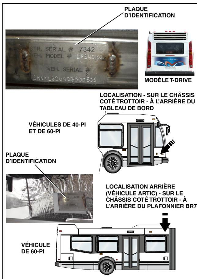
Figure B1 - Plaque d'identification sur la structure
