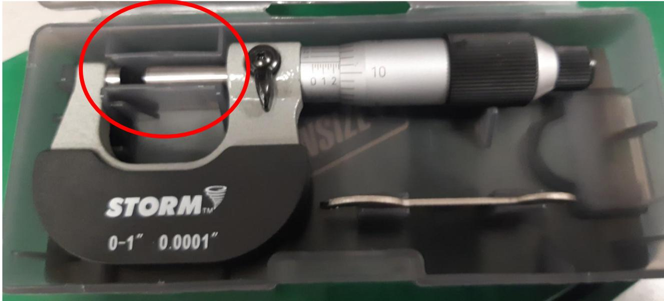
Ranger l'outil dans la boîte sans le refermer, car le fait de fermer le micromètre pourrait créer de la corrosion entre les 2 touches (la fixe et la mobile).
