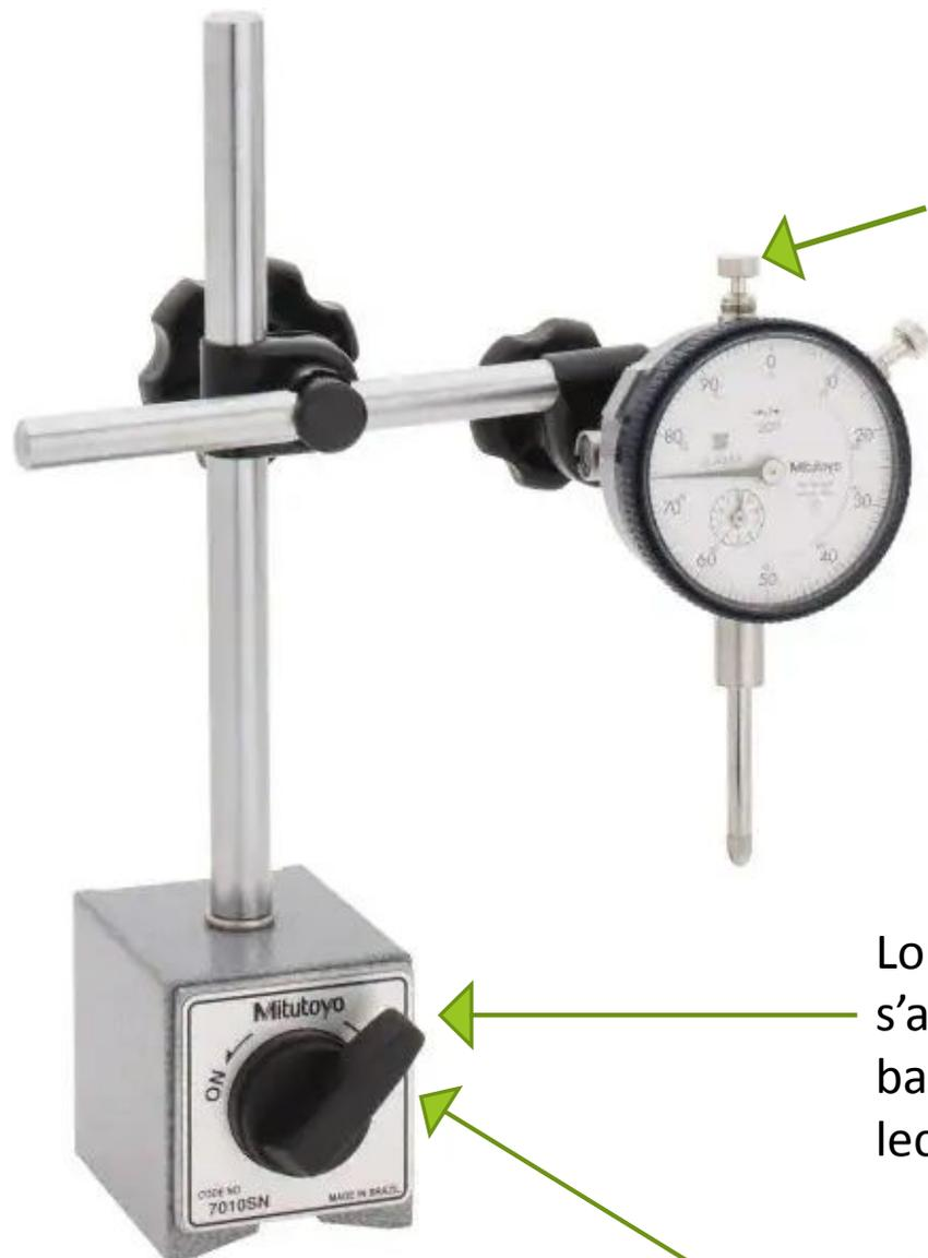
S'assurer que la tige bouge librement et qu'il lui reste de la place pour se déplacer. Il est important de permettre à l'aiguille de sortir ou rentrer librement.
