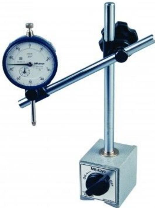
Le comparateur à cadran est un outils de mesure de précisions très utile à un mécanicien ,pour mesurer des jeux et des déplacements de pièce il est de plus en plus utilisé.
