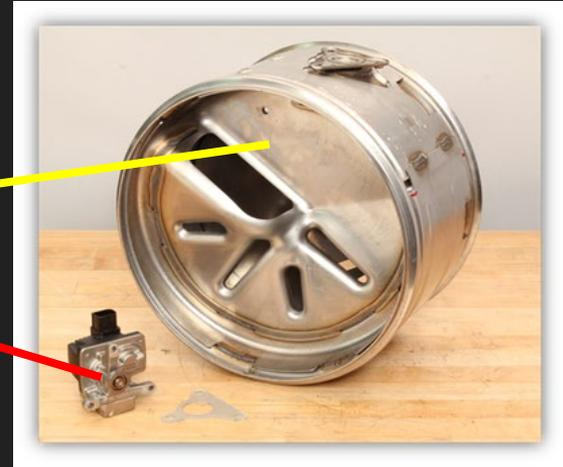
Le tube de décomposition DEF est utilisé pour la partie de réduction sélective du catalyseur du post-traitement. Le liquide d'échappement diesel, DEF, est injecté dans cette zone par la valve de dosage DEF. Le DEF est composé à 67,5% d'eau et à 32,5% d'urée. Lorsque le DEF atomisé est injecté dans le tube de décomposition, l'eau s'évapore et l'urée se déplace vers le catalyseur SCR.
