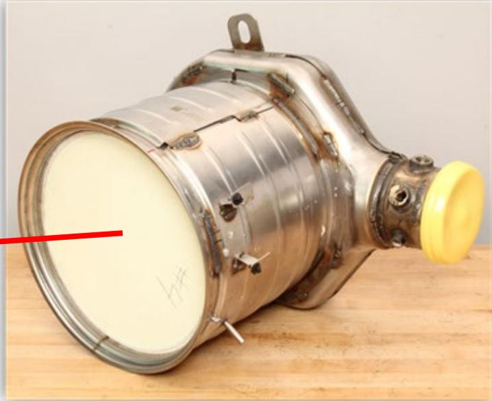
Le catalyseur SCR est un dispositif d'écoulement constitué d'un substrat en céramique avec une couche de lavage catalysée. Le but de ce catalyseur est de permettre une réaction des oxydes d'azote restant dans l'échappement et de réduire l'émission de NOx dans l'atmosphère.
