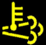
Haute température de l'échappement.
