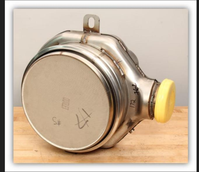
Le catalyseur d'oxydation diesel (DOC) est un dispositif d'écoulement constitué d'un substrat en céramique et d'une couche de lavage de catalyseur. Le but du DOC est de créer la chaleur nécessaire à la régénération du filtre à particules et au fonctionnement du SCR.
