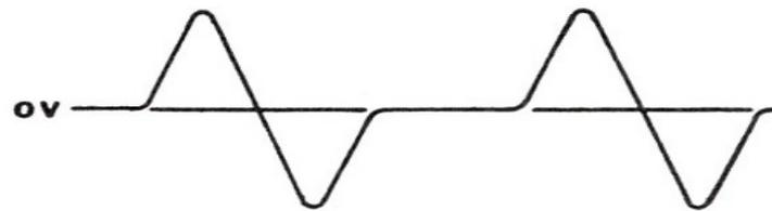
**VOLTAGE WAVEFORM FROM PICKUP**
