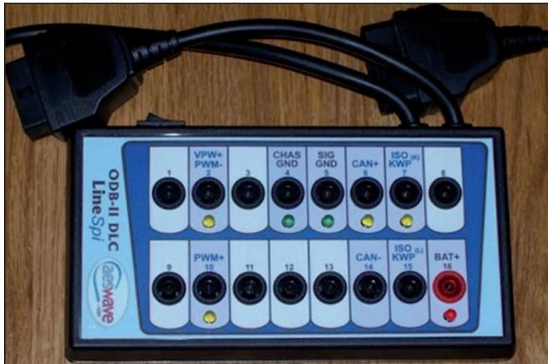
Le poste de vérification donne un accès protégé au seize broches de la prise DLC, permet de brancher un outil de diagnostic et offre la possibilité de visualiser les données transmises au moyen d'un afficheur. L'ensemble MP-1918 comporte des broches accessibles aux connecteurs DLC ou Deutsch sans avoir besoin d'y brancher un poste de vérification.
