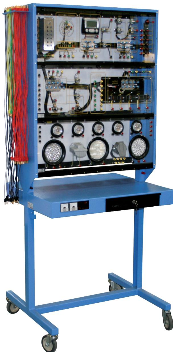
MP-1918-1S, Système d'éclairage multiplexé à simple côté
