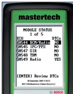
Le système CAN High-Speed possède cinq modules réveillés et mis en ligne, dont un avec un code DTC. Vérifions le plan de câblage pour visualiser l'architecture de la chaîne de modules.
