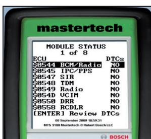
Nous constatons qu'il y a huit modules réveillés et qu'ils ne comportent aucun code d'anomalie (DTC). Il faut maintenant vérifier la concordance du nombre de modules avec ceux du plan de câblage du véhicule tel qu'illustré ci-dessous.
