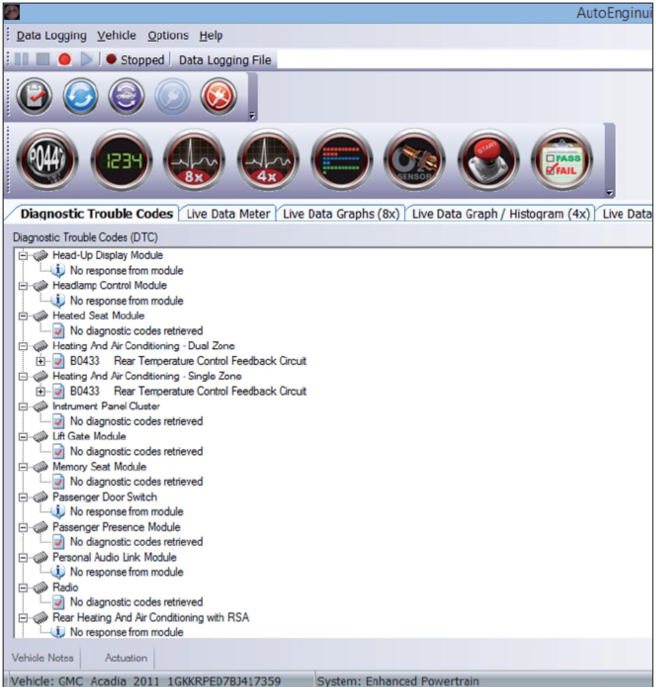
La prochaine étape sera de vérifier si les vingt-huit modules réveillés et mis en ligne selon l'écran de l'outil de diagnostic correspondent bien au même nombre de modules du plan de câblage. Voici un exemple d'un véhicule avec moins de modules balayés à l'aide d'un scanner portatif. Le message *Requesting module status* indique que le système CAN a transmis un signal réveil.
