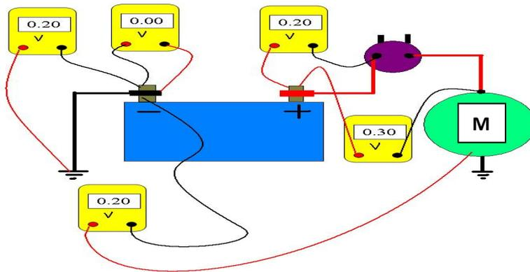
**Courant de fuite, (leak test)..... monté en série**
