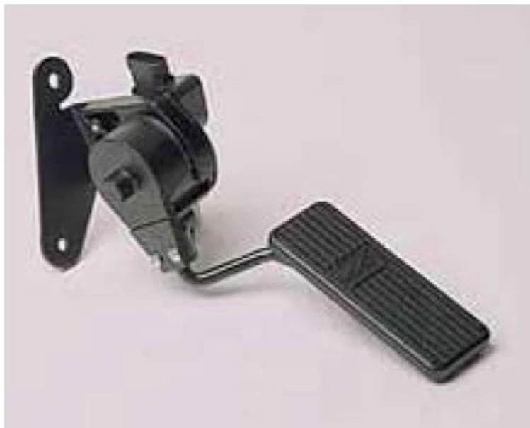
Le capteur de position de l'accélérateur (APS) indique à l'ECM la demande de puissance voulue par l'opérateur. Un capteur de ce type sur plusieurs modèles de
