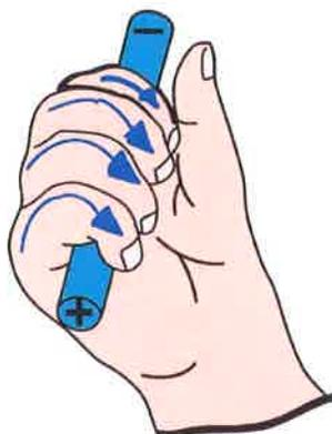
Figure 18 Règle de la main droite pour la direction de champ utilisée avec la théorie conventionnelle du débit
