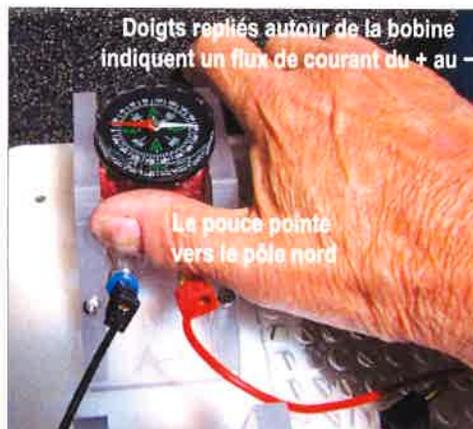
Figure 12 Règle de la main droite pour les bobines
