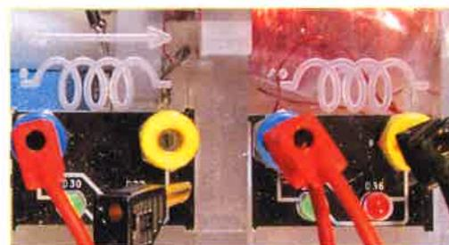
16. Poussez la bobine primaire d'avant en arrière, vers l'intérieur et l'extérieur de la bobine secondaire du module C, puis rebranchez aussitôt le fil de masse. Le multimètre devrait afficher un courant plus élevé que celui de l'étape 12.
