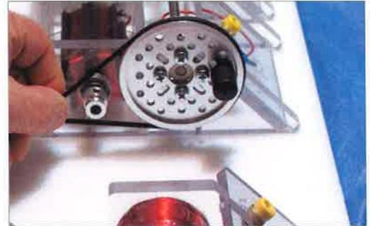
14. Enlevez la courroie d'entraînement de l'armature du moteur et le moteur tournera à nouveau.
