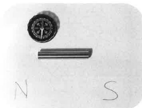
4. Continuez à déplacer la boussole vers l'autre extrémité. Vous devriez voir l'aiguille réagir aux lignes du flux magnétique de la tige.
