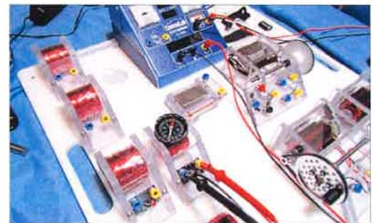
Une force électromotrice (F.E.M.) est créée et fait circuler le courant dans la direction opposée au courant de la batterie. Il s'agit alors d'une force contre-électromotrice (F.C.E.M.).
