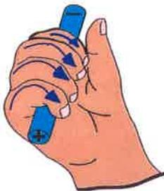
Figure 7 Règle de la main droite qui détermine la direction du champ à partir de la théorie classique du débit.
