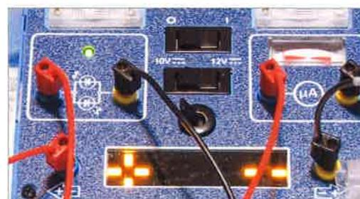
7. Lancez le moteur F-1 dans le sens horaire. La DEL de la diode bipolaire devrait maintenant s'allumer en rouge et le galvanomètre indiquer un flux de courant allant au maximum vers la droite.
