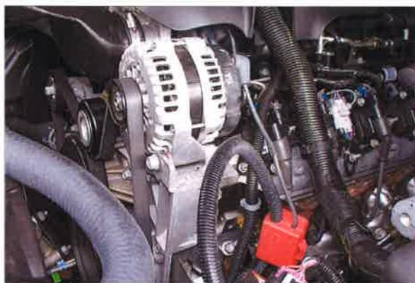
Figure 20 Alternateur entraîné par courroie
