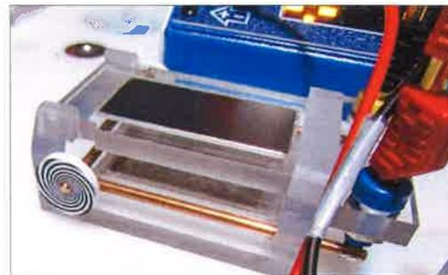
9. Lorsque la tige mobile du chariot se déplace d'avant en arrière, avec le débit du positif au négatif, l'indicateur du galvanomètre part complètement vers la gauche, ce qui indique une augmentation importante de courant en microampères.
