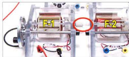
9. Le module F-1 représente un moteur à vitesse variable doté d'un jeu de balais mobiles et d'un collecteur à deux segments avec seulement deux bobines de champ magnétique. Le déplacement des balais vers l'avant permet d'augmenter la vitesse du moteur. Cette vitesse peut varier de trois façons :
