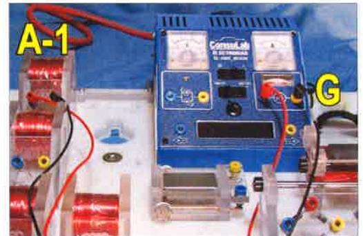
3. Faites glisser la tige aimantée à l'intérieur de la bobine, avec son pôle nord en premier. Vous devriez voir bouger l'indicateur à aiguille du galvanomètre.
