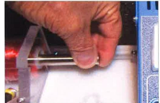
4. Le fait de déposer l'aimant dans la bobine génère beaucoup de lignes magnétiques, mais aucun courant selon le galvanomètre. La bobine ne produit du courant que lorsque le flux magnétique varie.
