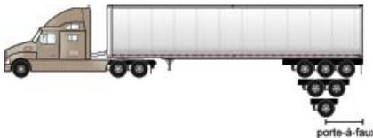
Distance mesurée à partir du centre de l'essieu simple, tandem ou tridem arrière jusqu'à la partie extrême arrière du véhicule, y compris le chargement.
