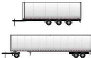
Un véhicule routier, y compris une semi-remorque dont l'avant porte sur un diabolo, relié au véhicule qui le tire par un système d'attache autre qu'une sellette d'attelage fixée sur le dessus de son cadre de châssis.
