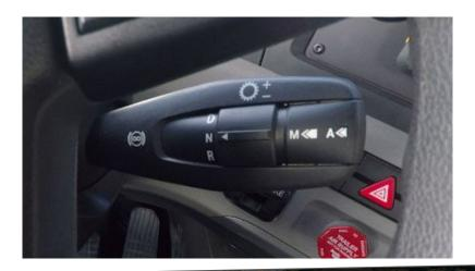
Pour changer les rapports, il faut lever le levier pour grader et le baisser pour rétrograder Gradation
