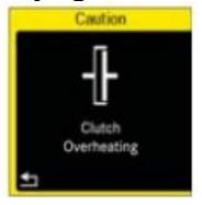
Lorsque ces indicateurs s'allument dans le tableau de bord, cela signifie que l'embrayage surchauffe et qu'il est possible que celle-ci cesse de fonctionner. Un système de protection peut alors débrayer momentanément l'embrayage, afin de permettre son refroidissement. Il sera donc impossible, dans ces
