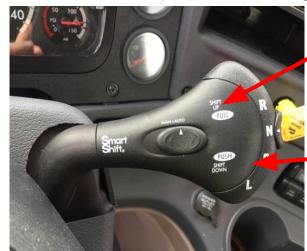
Le mode "**low**" permet entre autres de verrouiller au besoin un rapport de vitesse.
