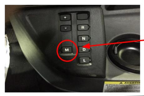
Pour changer les rapports, il faut appuyer sur + pour grader et sur - pour rétrograder.
