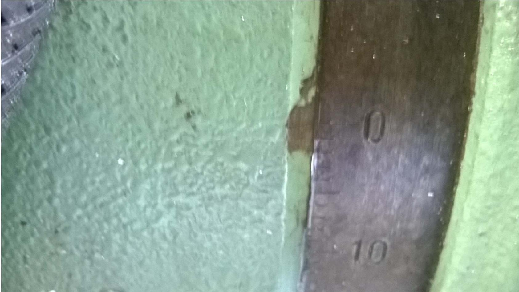
Déplacer jusqu'à  $17^\circ$  et reprendre le jeu jusqu'à  $15.5^\circ$
