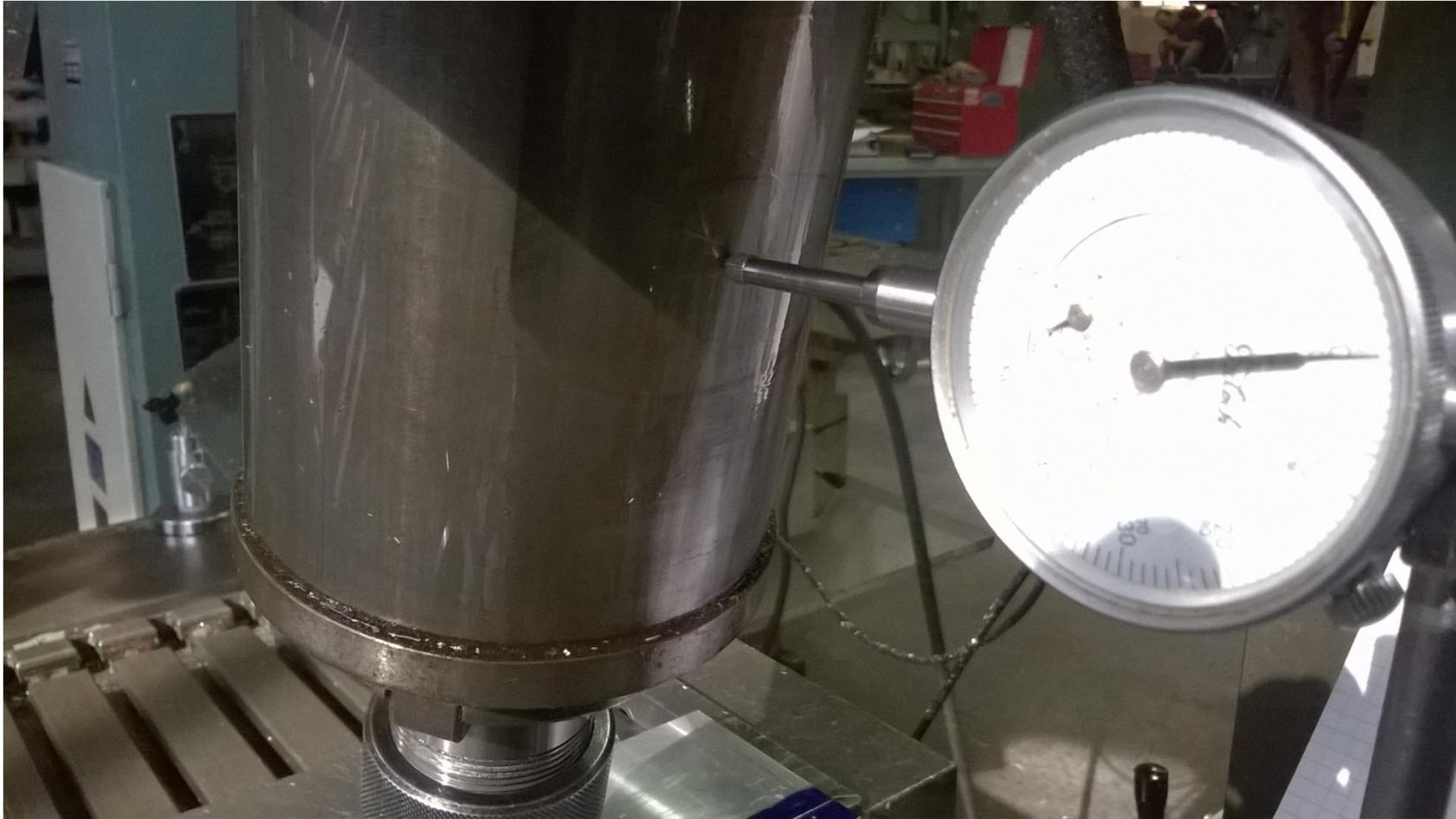
Mettre une pression en x sur le cadran et mettre à zéro.
