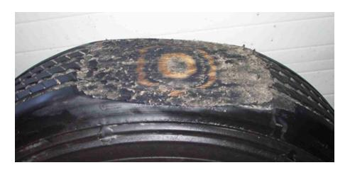
Ce type d'anomalie se produit habituellement sur une remorque, lorsque l'opérateur omet de vérifier le **libre mouvement de toutes les roues avant de prendre la route.** Également, une telle usure de moindre importance peut survenir lors d'un freinage d'urgence ou lors d'un blocage causé par système de freinage défectueux.
