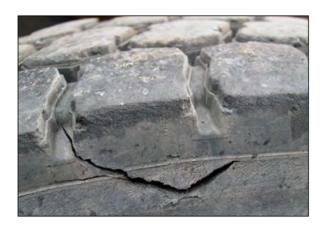
Plusieurs fissures peuvent se retrouver sur les différentes surfaces des pneus. Cependant, seules les imperfections permettant d'exposer la **toile de renforcement ou la ceinture d'acier** seront considérées comme des anomalies. Concernant les bosses sur les flancs et **les réparations déjà effectuées**, les tolérances devront être vérifiées par du personnel qualifié.
