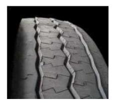
Ces déformations sont habituellement provoquées par des problèmes mécaniques dans les suspensions ou par des pièces ou des amortisseurs en mauvais état ainsi qu'un parallélisme des roues (alignement) défectueux. Une pression d'air inadéquate dans les pneus cause également des inégalités.
