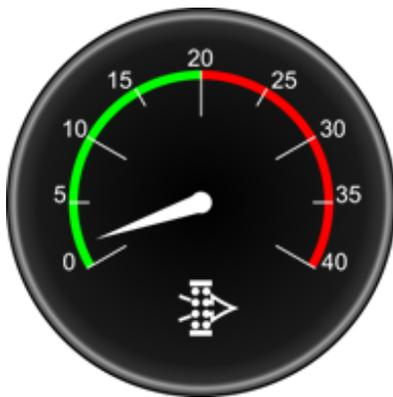
Lors de conditions normales d'utilisation, la lecture pourrait indiquer de 10 à 15 pouces H<sub>2</sub>O. Lorsque l'indicateur indique au-delà de 20 pouces H<sub>2</sub>O, cela signifie que le filtre à air est sale. Celui-ci doit donc être nettoyé ou changé. Le rendement du moteur va diminuer si le filtre n'est pas propre.
