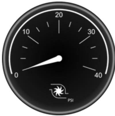
Plus le moteur est sous charge, plus la pression du turbo (2) augmente. Le maximum de pression varie d'un moteur à l'autre (environ 30 lb/po<sup>2</sup> à 60 lb/po<sup>2</sup> max). Lorsque le moteur ne subit aucune charge, il est normal que la pression se retrouve à zéro. Ce sont les gaz d'échappement qui entraînent la turbine motrice du turbo. Ces gaz se dirigent vers le filtre à particules (8). Ce filtre contribue à réduire la pollution de l'air en y retenant les particules de suie.
