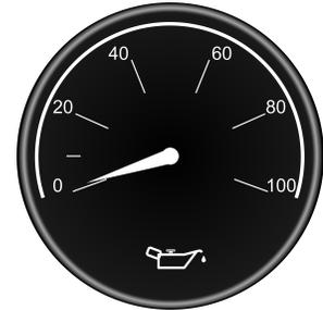
N. B. Au démarrage par temps froid, la pression d'huile peut augmenter de façon significative momentanément.
