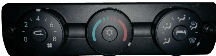
Le chauffage intérieur est directement relié au reste du système de refroidissement du véhicule. Une odeur sucrée ou des vitres intérieures toujours humides peuvent indiquer un bris dans le système de chauffage du véhicule.
