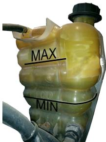
Le niveau du liquide de refroidissement est adéquat. **Avant d'en rajouter, toujours suivre les recommandations du fabricant.** Vous retrouverez ces informations à proximité du système de refroidissement ou dans le manuel du fabricant.
