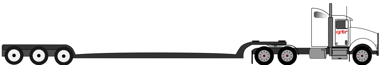
Semi-remorque fardier; col de cygne: Transport de machineries lourdes ou de chargement hors normes
