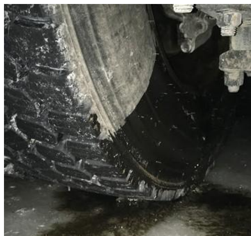
Exemples de défauts causés par des fuites du joint d'étanchéité.
