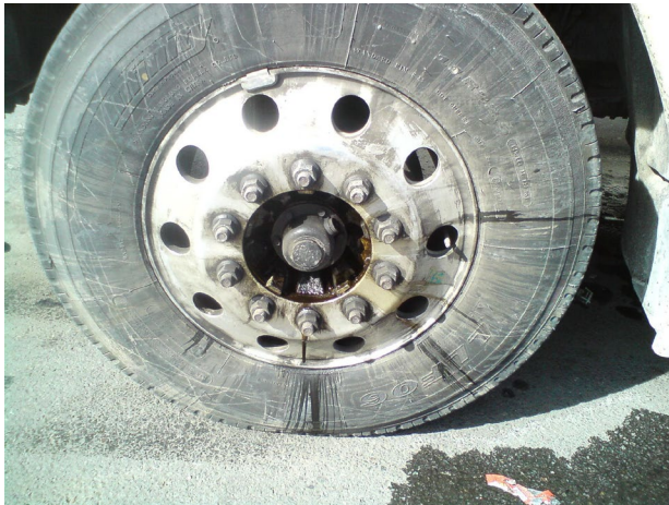
Exemples de défauts causés par des fuites du joint d'étanchéité.
