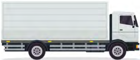
Camion avec essieu moteur arrière simple (pont moteur simple)
