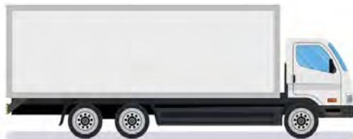
Camion avec essieu moteur arrière double ou tandem (pont moteur double ou tandem)
