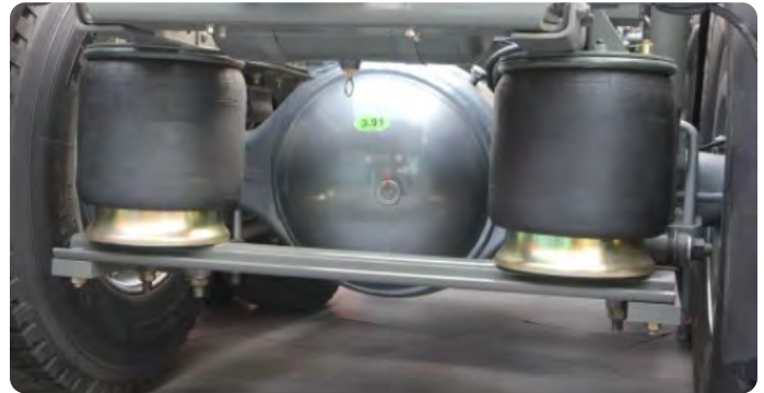
Suspension pneumatique sur essieu moteur
