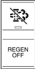
Cet interrupteur est utilisé pour activer une régénération du système antipollution.
