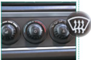
**Note :** La défectuosité ne vise pas la température de l'air soufflé. Par ailleurs, en hiver, il serait important de vérifier que la température permette le dégivrage du pare-brise afin d'assurer la meilleure visibilité pour une conduite sécuritaire.
