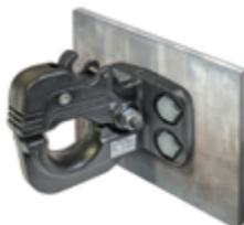
**Note :** Il est important que le dispositif de verrouillage du crochet soit fonctionnel pour éviter les risques de séparation de l'ensemble de véhicules.
