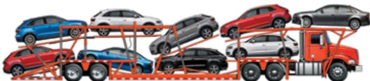
Un véhicule dont la masse individuelle est de 4 500 kg ou moins est généralement constitué de pièces mécaniques mobiles qui lui permettent de se mouvoir. Certaines de ces pièces (pneus, suspension, etc.) permettent de libres mouvements verticaux. Ces caractéristiques font en sorte que le transport de tels véhicules nécessite l'utilisation de systèmes d'arrimage spécifiques.
