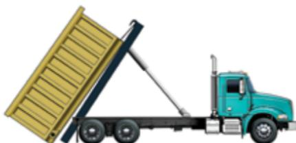
Un conteneur amovible est un conteneur spécialisé qui peut être chargé sur un châssis à cadre basculant ou être déchargé de ce châssis au moyen d'un mécanisme de levage, grâce au système intégré de roulage dont il est pourvu. Ce type de conteneur est transporté à l'aide de véhicules spécialement adaptés pour arrimer le conteneur par l'avant et par l'arrière. Le Règlement prescrit des règles particulières d'arrimage pour les types de conteneurs transportés sur ces véhicules adaptés.
