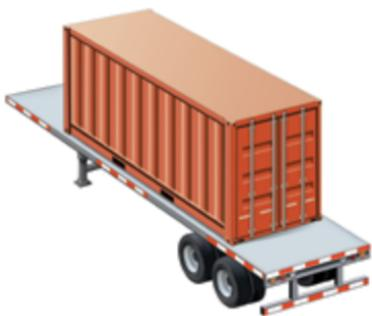
Un conteneur intermodal est une caisse de dimensions normalisées utilisée pour le transport des marchandises. Il est doté de dispositifs intégrés de verrouillage, ce qui permet d'arrimer le conteneur à un véhicule à châssis porte-conteneur ou à un véhicule à plate-forme. Pour tenir compte des particularités des conteneurs intermodaux, le Règlement prévoit des règles particulières d'arrimage.
