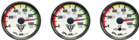
de service de l'autobus, du camion ou du tracteur. Étant donné que le système de freinage de service compte deux circuits indépendants (voir p. 91), on trouve deux manomètres sur le tableau de bord, soit un pour chaque circuit. Il est également possible qu'il n'y ait qu'un seul manomètre avec deux aiguilles, soit une pour chacun des circuits. Il n'y a toutefois pas de manomètre pour le réservoir d'alimentation.
