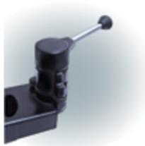
La commande de freinage à main est fixée à la colonne de direction ou placée sur le tableau de bord. Elle est parfois utilisée par les conducteurs pour vérifier si l'attelage de la semi-remorque a été fait correctement. Elle est également utile pour vérifier le fonctionnement du frein de service de la remorque ou de la semi-remorque après la manœuvre d'attelage.
