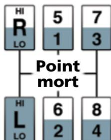
Les transmissions à 8, 13 et 18 vitesses suivent généralement le schéma ci-dessus.
