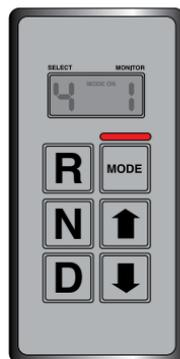
Avant de sélectionner un rapport de vitesse, vous devez d'abord appuyer sur le bouton MODE, pour passer du mode automatique au mode manuel.
