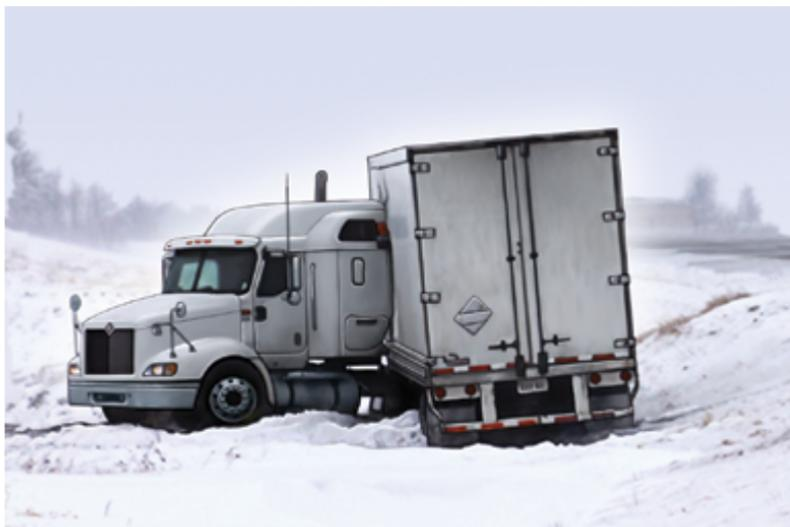
La mise en portefeuille survient lorsque, sous la poussée exercée par la semi-remorque, le tracteur est entraîné vers la droite ou vers la gauche. L'angle formé par le tracteur et la semi-remorque, qui se rapprochent l'un de l'autre pour former la mise en portefeuille, est alors supérieur à 90 degrés.
