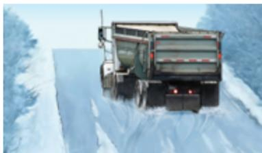
est trop élevée pour l'état de la chaussée. Dans une montée, les roues patinent alors sans pourtant réussir à faire avancer votre véhicule, et l'arrière du véhicule dévie de sa trajectoire.
