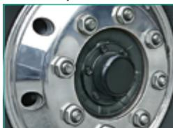
Roue avec moyeu lubrifié à la graisse
