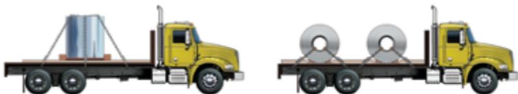
Une bobine de métal est un objet cylindrique dont la masse est importante. En position verticale ou horizontale, ces particularités font en sorte qu'il est nécessaire d'utiliser des mécanismes d'immobilisation efficaces, en plus d'un nombre d'appareils d'arrimage minimal pour chacune des bobines.
