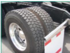
**Recommandation :** Il peut être difficile de constater qu'un pneu jumelé est à plat lorsque le second pneu de l'assemblage est en bon état. Ainsi, pour vérifier si un pneu jumelé est à plat, il est recommandé de le cogner avec un marteau ou un objet similaire.
