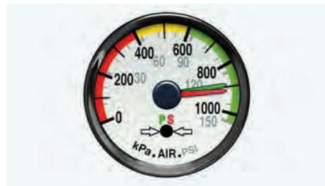
Les manomètres à air comprimé indiquent la pression d'air contenue dans les réservoirs de service de l'autobus, du camion ou du tracteur. Étant donné que le système de freinage de service compte deux circuits indépendants, on trouve deux manomètres sur le tableau de bord, soit un pour chaque circuit : le primaire et le secondaire. Il est également possible qu'il n'y ait qu'un seul manomètre avec deux aiguilles, soit une pour chacun des circuits.
