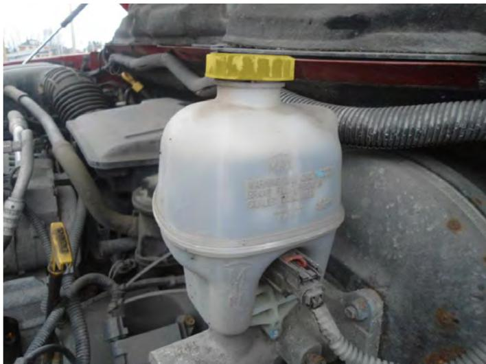
FIGURE 57 | Réservoir du maître-cylindre d'un autobus scolaire
