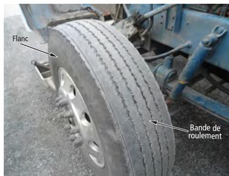
FIGURE 39 | Pneus jumelés du même assemblage de roues
