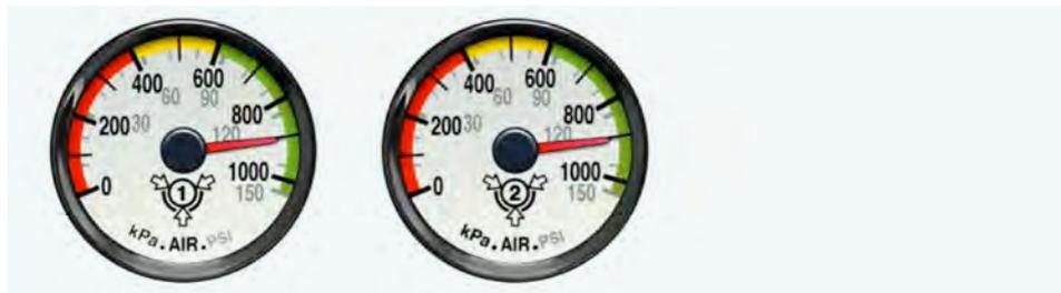
FIGURE 63 | Manomètre à air comprimé à deux aiguilles
