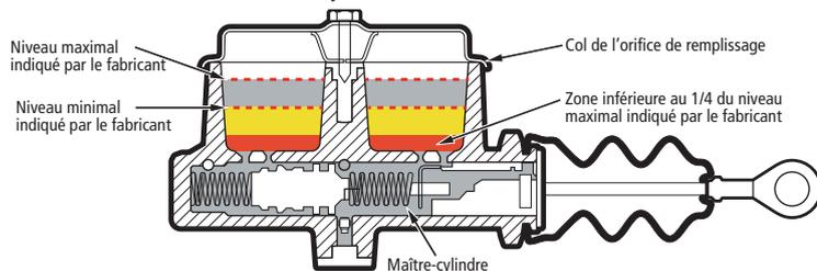
FIGURE 59 | Réservoir du maître-cylindre **sans** indicateurs du fabricant
