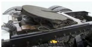
FIGURE 2 | Plaque et pivot d'attelage
