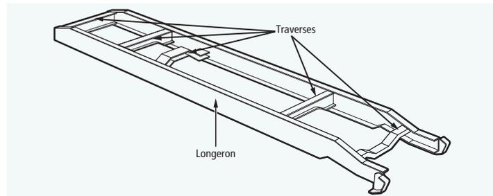
FIGURE 19 | Châssis monocoque
