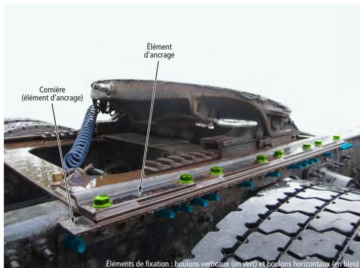
FIGURE 7 | Éléments de fixation de la sellette d'attelage
