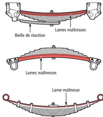
FIGURE 53 | Ressort à lame en composite
