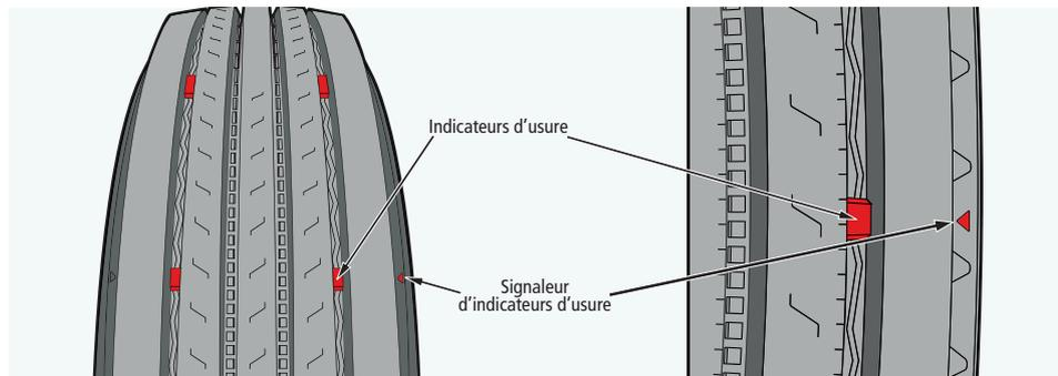
FIGURE 38 | Pneu simple
