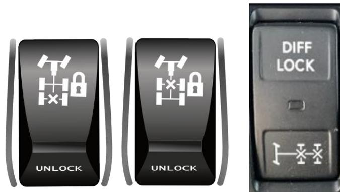
Lorsque le véhicule en est équipé, le conducteur a la possibilité d'engager le(s) différentiel(s) interroues afin **d'augmenter** la traction dans des situations particulières.
