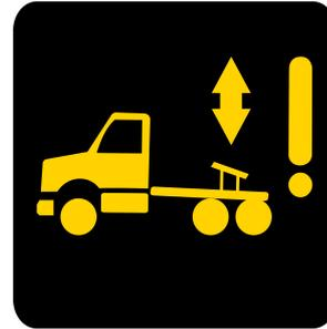
Certains témoins lumineux de rappel sont intégrés à même l'interrupteur, alors que d'autres seront visibles **dans le tableau de bord** ou directement dans **l'écran multifonctions**. Ceux-ci nous rappellent que la **suspension est abaissée**.
