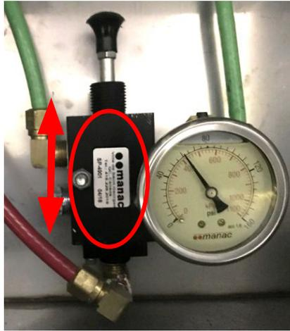
La commande de la semi-remorque permet, **tout comme l'interrupteur** sur un camion, la mise en fonction de la suspension pneumatique. Le gonflement tout comme le dégonflement peuvent être actionnés de manière manuelle ou **automatique**.
