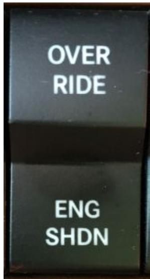
Lorsque le témoin d'arrêt du moteur “engine shutdown” est allumé, il peut être nécessaire d'utiliser l'Interrupteur “**Override**” afin de déplacer le véhicule ou le remettre en marche. S'il n'y a pas d'interrupteur, arrêter le moteur avec la clé et redémarrer.
