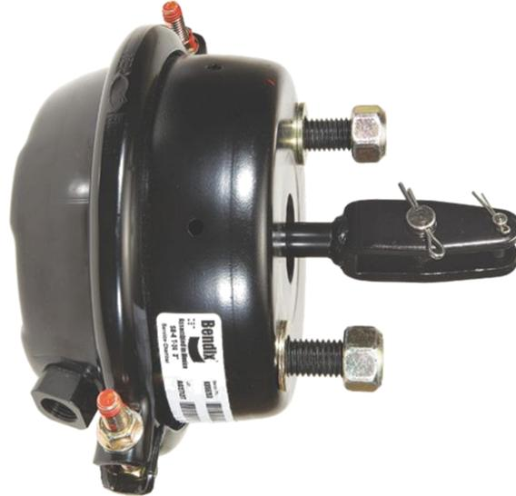
Le **récepteur de freinage** agit à l'aide de l'air comprimé comme un multiplicateur de force qui soumettra une pression sur le levier réglable.
