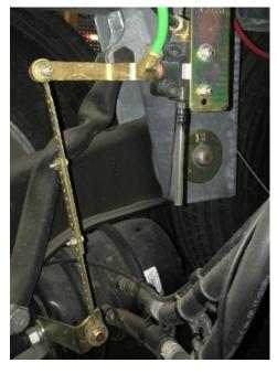
La commande de la semi-remorque permet, **tout comme l'interrupteur** sur un camion, la mise en fonction de la suspension pneumatique. Le gonflement tout comme le dégonflement peuvent être actionnés de manière <u>manuelle</u> ou **automatique**.
