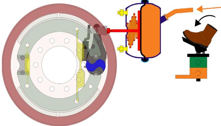
Plus la pression d'air est élevée, plus la membrane exerce une charge sur la tige de poussée qui, à son tour, exerce une pression sur le levier réglable. Le levier réglable impose une force de rotation sur l'arbre à cames en « S ». C'est l'action de cette rotation qui agit sur les segments de freins et qui provoque le serrage des freins.
