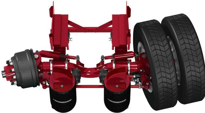
Comme son nom l'indique, l'essieu autovireur tourne **automatiquement** en suivant le mouvement de l'équipement. Sur une semi-remorque, il est installé à l'avant du \_\_\_\_\_ d'essieux triple (au Québec) et peut être chaussé en montage **simple** ou **jumelé**. Il est **constamment au sol** lors des virages, du moins lorsque **la charge transportée** nécessite sa présence. Cependant, il devra être relevé
