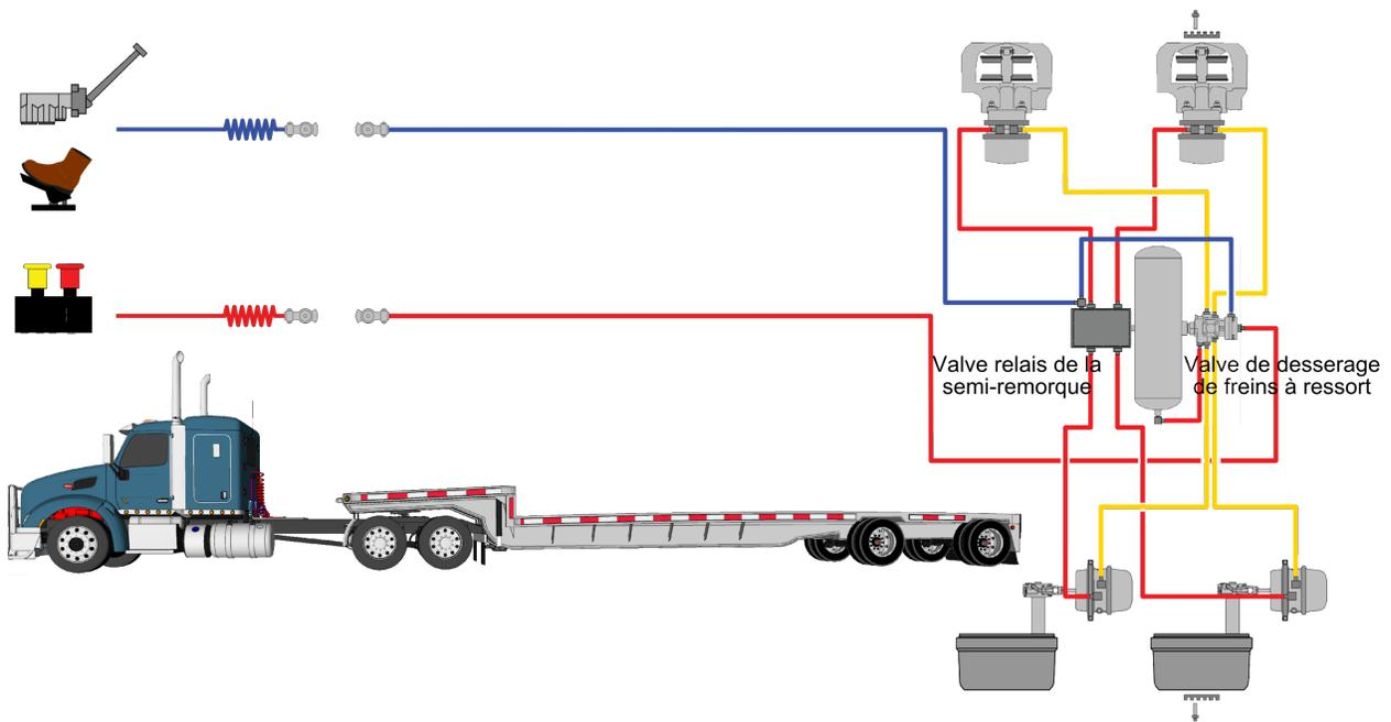
Lorsque le bouton rouge est poussé, la semi-remorque s'alimente en air. Lorsque la pression est suffisante, les freins de stationnement se desserrent. L'alimentation en air de la semi-remorque est assurée par le boyau rouge.
