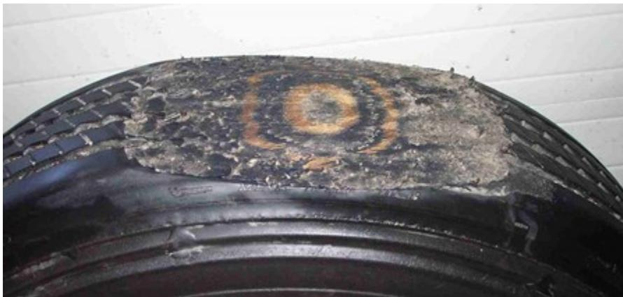
Ce type d'anomalie se produit habituellement sur une remorque, lorsque l'opérateur omet de vérifier le **libre mouvement de toutes les roues avant de prendre la route**. Également, une telle usure de moindre importance peut survenir lors d'un freinage d'urgence ou lors d'un blocage causé par système de freinage défectueux.
