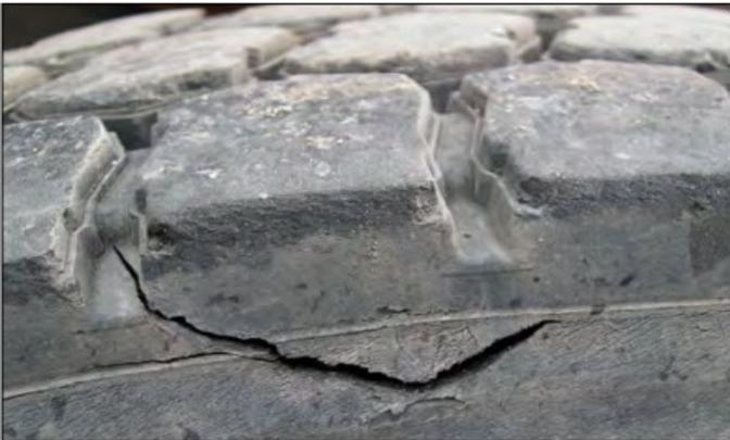
Plusieurs fissures peuvent se retrouver sur les différentes surfaces des pneus. Cependant, seules les imperfections permettant d'exposer la **toile de renforcement ou la ceinture d'acier** seront considérées comme des anomalies. Concernant les bosses sur les flancs et **les réparations déjà effectuées**, les tolérances devront être vérifiées par du personnel qualifié.
