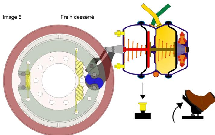
En poussant sur le bouton jaune, l'air pénètre dans le cylindre et pousse sur le diaphragme, comprimant ainsi le ressort du frein de stationnement; les freins sont alors desserrés.
