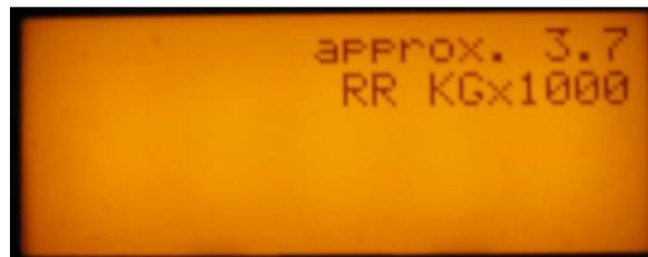
du camion. Le second indicateur (à droite) indique, comme une balance, le poids approximatif en **KG** sous les roues arrière, donc 3 700 kg pour un tracteur seul « bobtail ». La pression équivalente en **PSI** est généralement près de 10.
