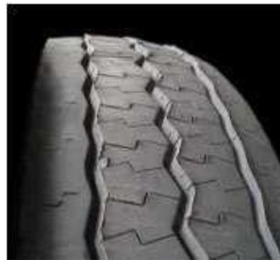
Ces déformations sont habituellement provoquées par des problèmes mécaniques dans les suspensions ou par des pièces ou des amortisseurs en mauvais état ainsi qu'un parallélisme des roues (alignement) défectueux. Une pression d'air inadéquate dans les pneus cause également des inégalités.
