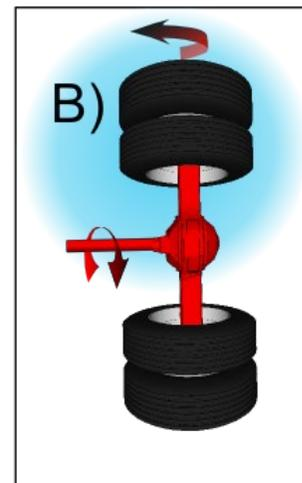
Dans l'illustration A, l'adhérence des pneus est égale sur chaque pneu portant. Par contre, dans l'illustration B, l'adhérence des pneus de droite est réduite. Par conséquent, toute la puissance est dirigée vers ce groupe de pneus.
