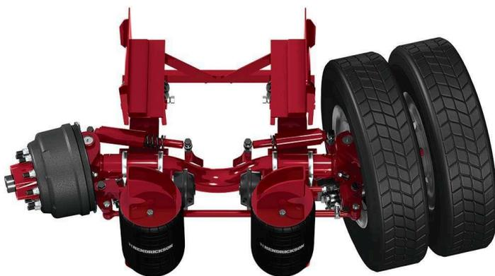
Comme son nom l'indique, l'essieu autovireur tourne **automatiquement** en suivant le mouvement de l'équipement. Sur une semi-remorque, il est installé à l'avant du **groupe** d'essieux triple (au Québec) et peut être chaussé en montage **simple** ou **jumelé**. Il est **constamment au sol** lors des virages, du moins lorsque la **charge transportée** nécessite sa présence. Cependant, il devra être relevé
