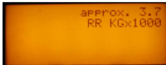
indicateur (à droite) indique, comme une balance, le poids approximatif en **KG** sous les roues arrière, donc 3 700 kg pour un tracteur seul « bobtail ». La pression équivalente en **PSI** est généralement près de 10.
