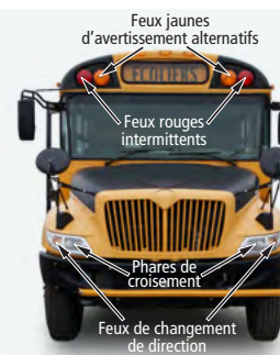
FIGURE 32 | Phares et feux avant d'un autobus scolaire
