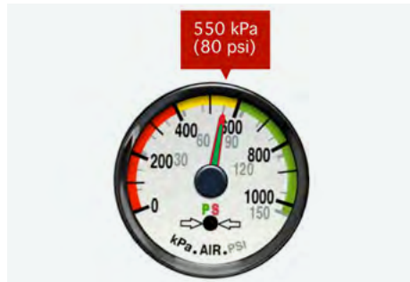
FIGURE 70 | Manomètre indiquant une pression de 550 kPa (80 lb/po 2 )
