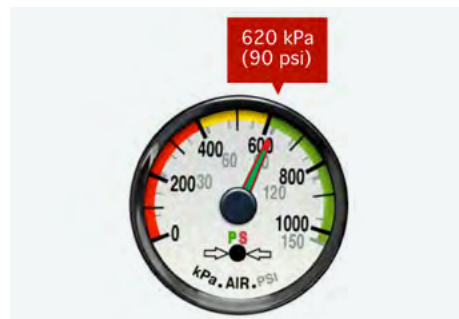
FIGURE 68 | Manomètre indiquant une pression de 620 kPa (90 lb/po 2 )
