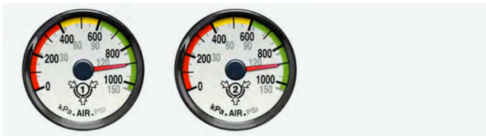
FIGURE 62 | Manomètres à air comprimé
