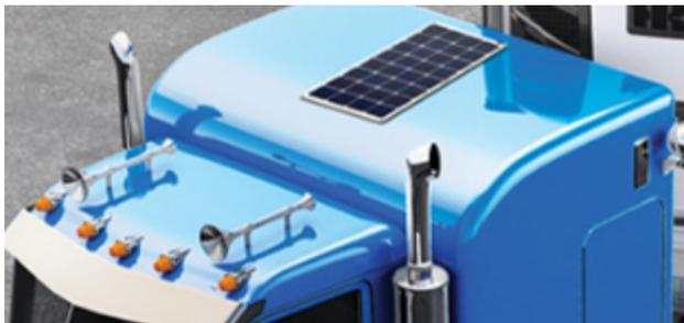
L'utilisation de panneaux solaires permet de fournir de l'énergie aux batteries. Ainsi, lors d'arrêt prolongé, entre autres, cet équipement est conçu pour assurer une charge adéquate au système électrique.
