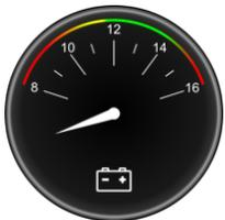
L'alternateur fournit le courant dans le système de charge. La tension sur le voltmètre doit se situer entre 12 et 14 volts.
