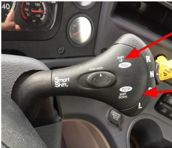
Le mode “**low**” permet entre autres de verrouiller au besoin un rapport de vitesse.
